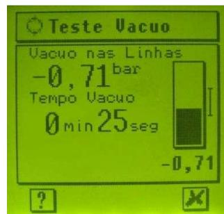
Informe del resultado de la prueba de vacío
