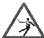
Tanto na rede elétrica quanto em sistemas elétricos de veículos automotivos, ocorrem tensões perigosas. Ao tocar peças com tensão aplicada (por exemplo: bobina de ignição), existe o risco de descarga elétrica em função de isolamento danificada (por exemplo: fissuras em cabos de ignição). Isto se aplica tanto ao lado primário como secundário do sistema de ignição, ao chicote e respectivas conexões, sistemas de iluminação (Litronic) e à conexão de aparelhos de teste.
