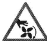
Em veículos sem trava de deslocamento existe, por exemplo, o risco de ser esmagado contra uma bancada. Nos motores em funcionamento ou mesmo parados existem peças rotativas e móveis (por exemplo: polias), que podem provocar ferimentos em dedos e braços. Principalmente em ventiladores elétricos existe o risco de acionamento inesperado mesmo com o motor ou a ignição desligados.
