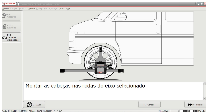
Montar as cabeças nas rodas dianteiras
