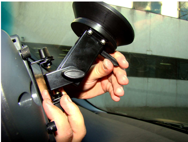
Figura 12: Alavanca da ventosa no aparelho
