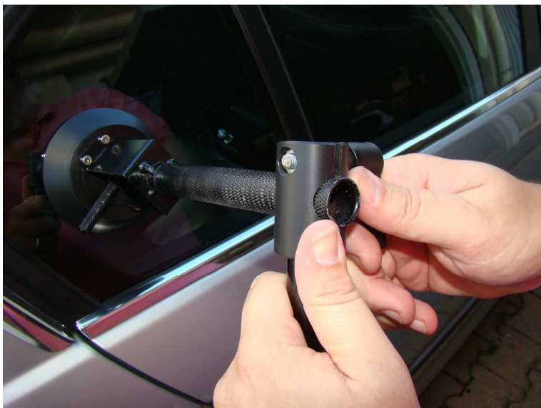
Figura 22: Colocação do braço telescópico
