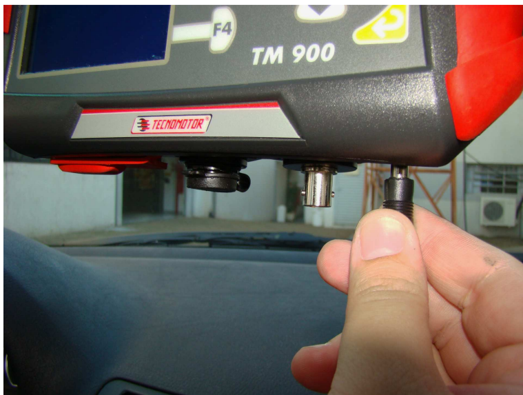
Figura 9: Alimentação 12V pelo conector P4 do TM 900
