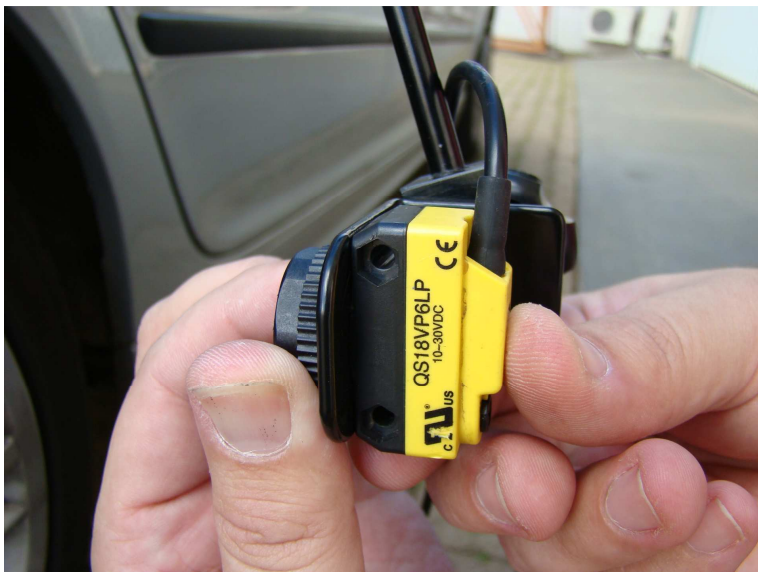
Figura 25: Colocação do sensor de velocidade
