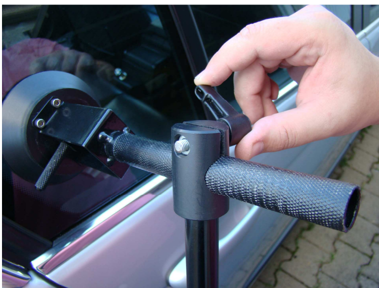
Figura 23: Alavanca de aperto do braço telescópico
