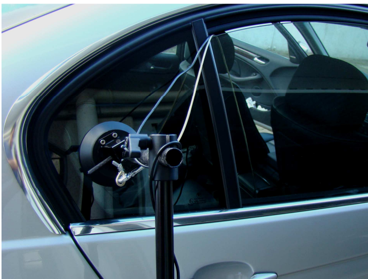
Figura 29: Fio e cabo de segurança do sensor de velocidade passando pela janela
