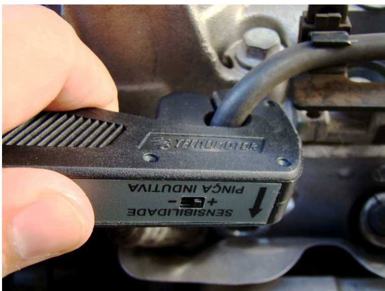
Figura 37: Chave de sensibilidade da pinça indutiva
