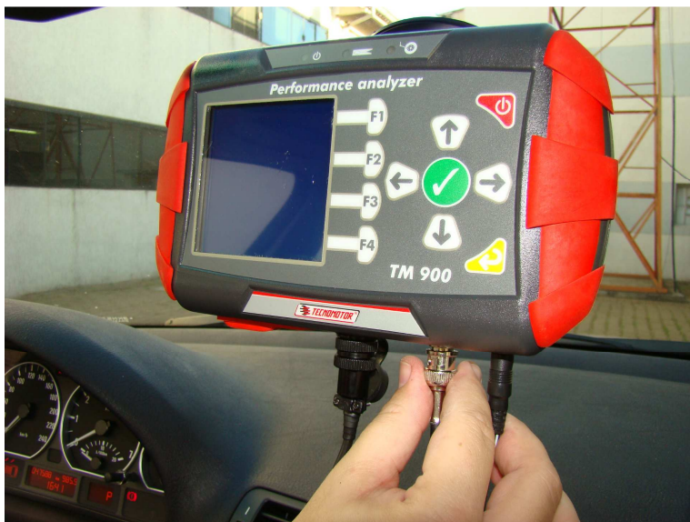
Figura 45: Conexão da pinça indutiva ao TM 900
