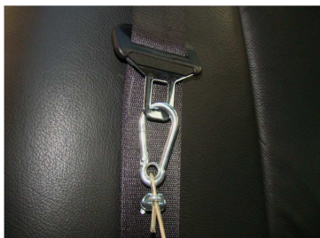
Figura 21: Possíveis pontos para prender o cabo de segurança do sensor: encosto de cabeça do banco, cinto de segurança, trilho do banco, alça do teto
