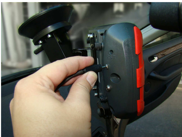
Figura 40: Conexão do sensor de temperatura ao TM 900
