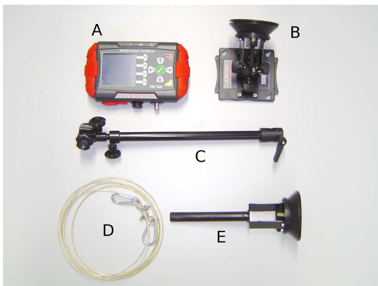
Figura 4: Acessórios do TM 900
