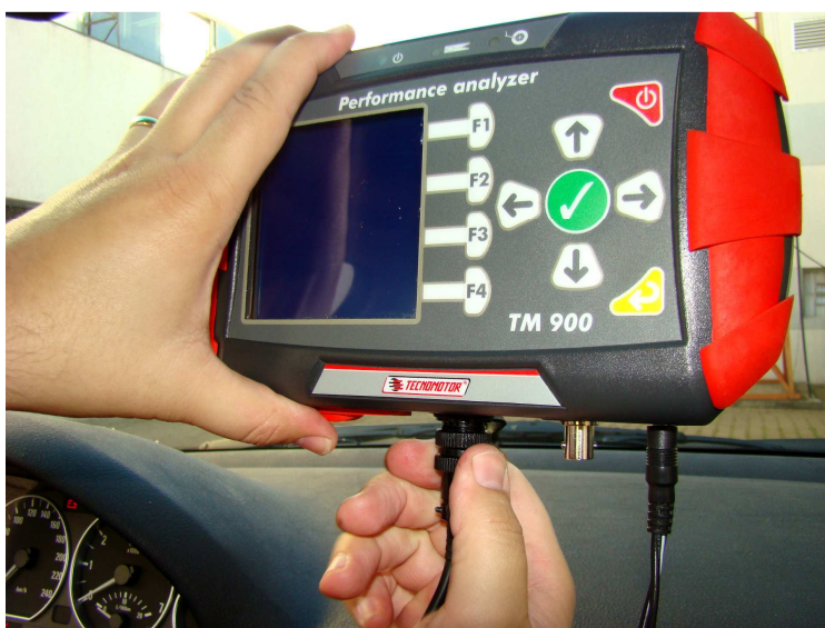
Figura 30: Conector do sensor de velocidade no TM 900
