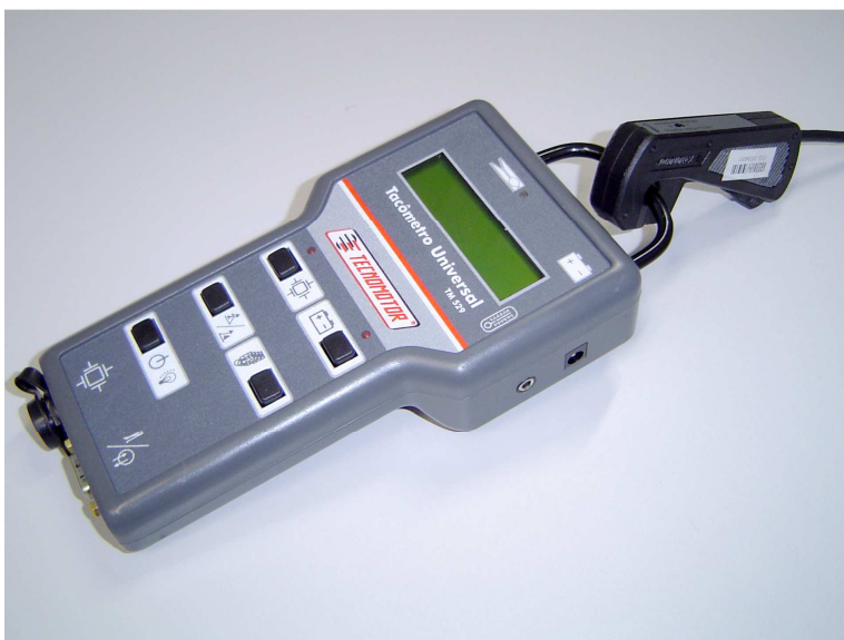
Figura 36: Pinça indutiva conectada na trave do TM 529
