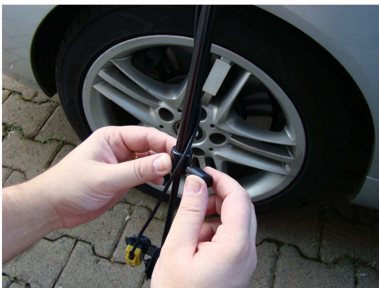
Figura 26: Aperto das manoplas de ajuste do braço
