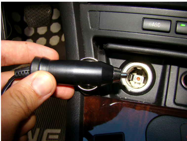
Figura 8: Conectando à tomada de 12V do veículo
