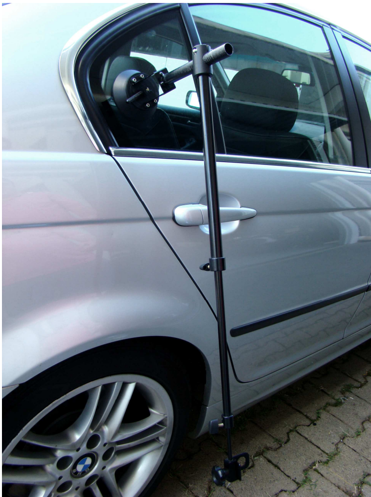
Figura 24: Ventosa e braço telescópico montados
