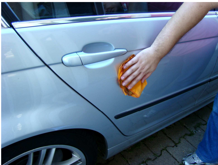
Figura 16: Limpeza da superfície para a ventosa do sensor de velocidade
