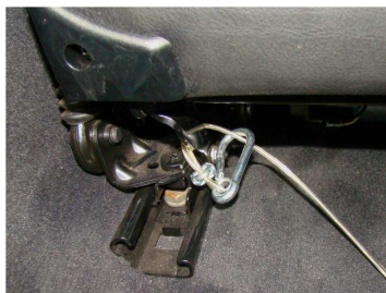
Figura 21: Possíveis pontos para prender o cabo de segurança do sensor: encosto de cabeça do banco, cinto de segurança, trilho do banco, alça do teto
