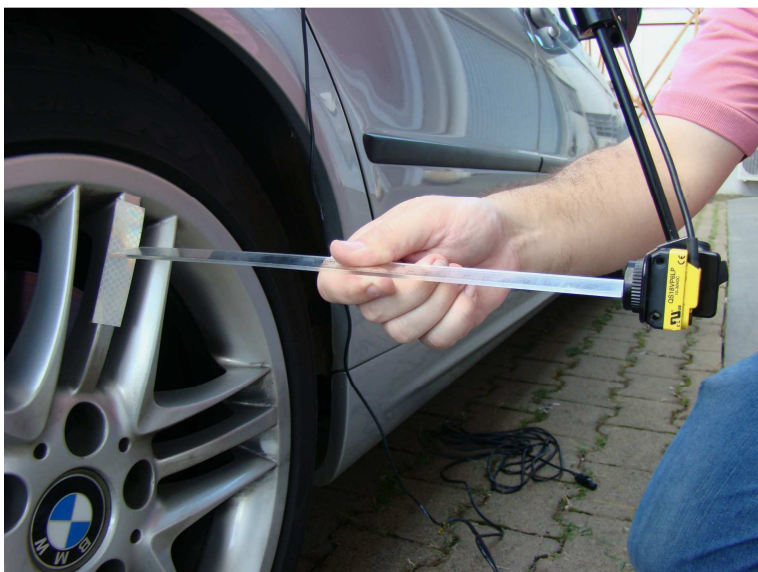
Figura 28: Distância entre o sensor e o adesivo espelhado
