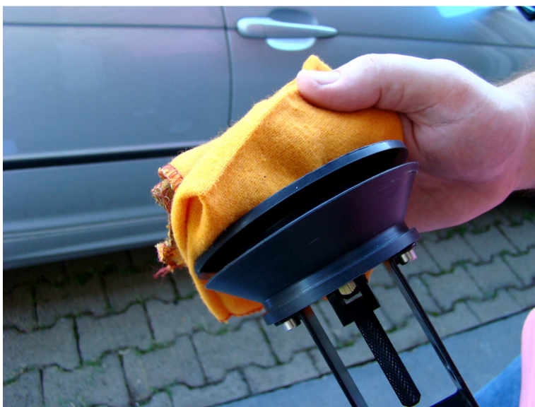
Figura 18: Limpeza da ventosa do sensor de velocidade
