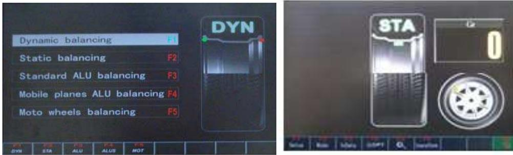
Abaixe a tampa ou pressione F9 para iniciar o giro, ao parar o valor de desequilíbrio externo será exibido no monitor. Para inserir o chumbo no lugar correto, gire a roda até que uma identificação do ponto exato para inserir o chumbo seja exibido no monitor. Para facilitar a fixação correta do chumbo, pressione o pedal do freio, de modo a travar a roda.
