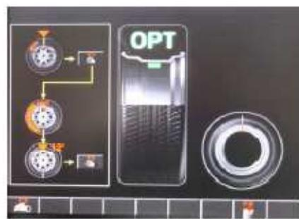
Gire a roda até a posição de 12h, pressione a tecla F1 para memorizar o ponto, com um giz faça uma marca no pneu.
