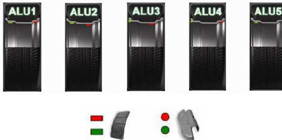
O processo de medição ALU é o mesmo que o modo dinâmico e estático. Após as medições, coloque um contrapeso na posição 01:00. Na posição 02:00, 03:00 e 04:00, coloque uma presilha de contrapeso.
