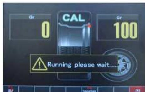
Insira o peso padrão de 100g do lado externo da roda, na posição de 12h, utilize a régua exibida na tela acima da roda para ajudá-lo a encontrar o ponto exato para encaixe do contrapeso. Pressione F9 para iniciar o giro e, aguarde a roda parar de girar totalmente.
