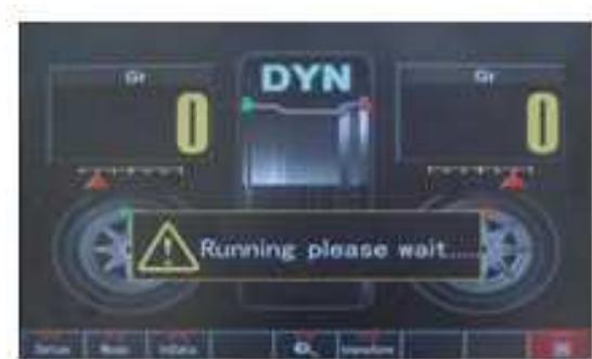
Assim que a roda parar de girar, os valores de desequilíbrio do lado interno e externo da roda serão exibidos no monitor. Para inserir o chumbo no lugar correto, gire a roda até que uma identificação do ponto exato para inserir o chumbo seja exibido no monitor. Para facilitar a fixação correta do chumbo, pressione o pedal do freio, de modo a travar a roda.
