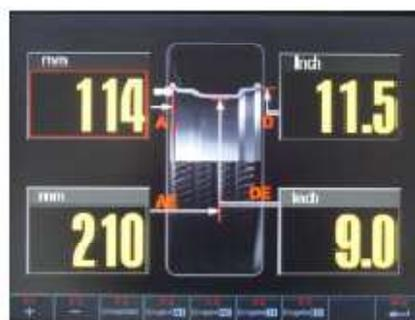
Caso o parâmetro A não seja exibido automaticamente ao puxar a régua, pressione F3 para entrar no parâmetro de entrada ALU 1S e ALU 2S. Na tela dos parâmetros, eles podem ser alterados ou inseridos manualmente, conforme detalhado no item 7.4.
