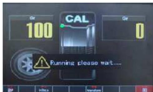
Insira o peso padrão de 100g do lado interno da roda, na posição de 12h, utilize a régua exibida na tela acima da roda para ajudá-lo a encontrar o ponto exato para encaixe do contrapeso. Pressione F9 para iniciar o giro e, aguarde a roda parar de girar totalmente.
