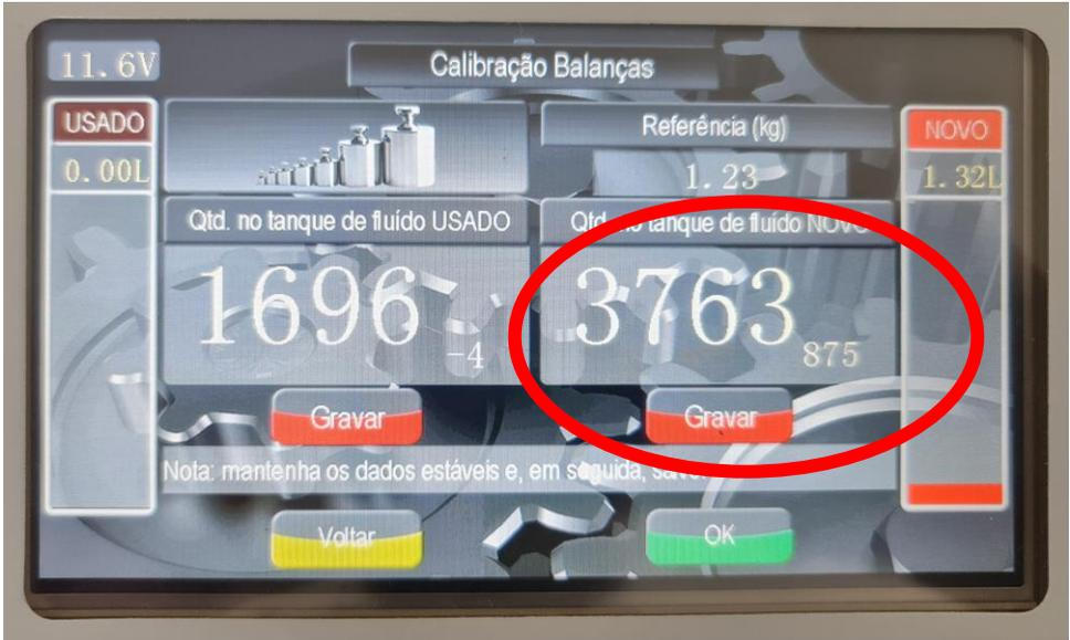
Escolha qual dos tanques vai iniciar a calibração, neste caso vamos começar pelo tanque de fluido novo.
