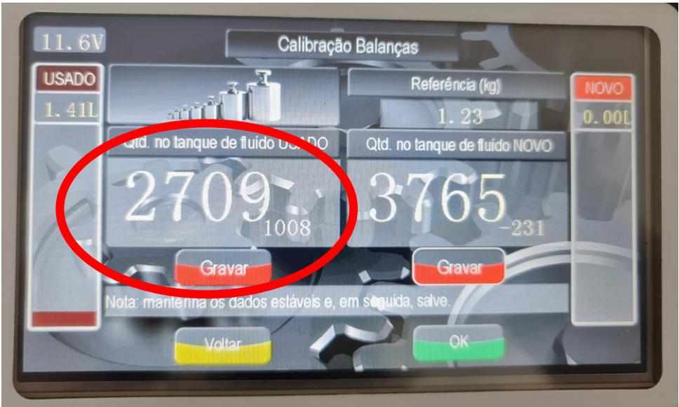
Na sequência, remova o peso do tanque de fluido no novo e coloque sobre o tanque de fluido usado.
