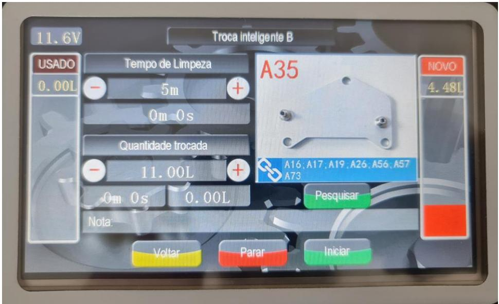
Na interface de TROCA INTELIGENTE é apresentada a flange necessária que deve ser afixada diretamente na transmissão, no lugar do trocador de calor, ou será exibido as conexões e mangueiras necessárias para conectar a TD 7105 ao sistema de transmissão automática.
