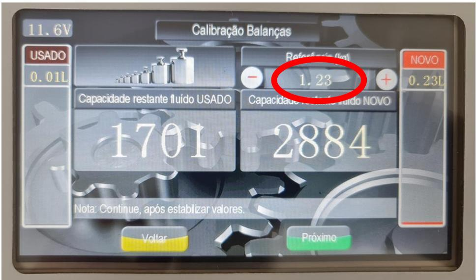
Nesta interface, informe para a TD 7105 o valor do peso que será utilizado no processo de calibração através dos botões “+” e “-”.
