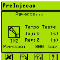
Tela do teste de pré-injeção: executando o teste de vazão
