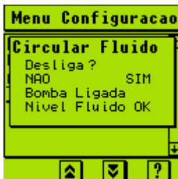
Tela de manutenção do fluido de teste: retirando o ar do sistema
