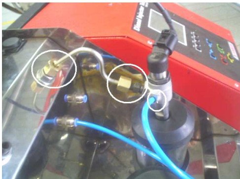
Injetor Siemens conectado na TM 507-III
