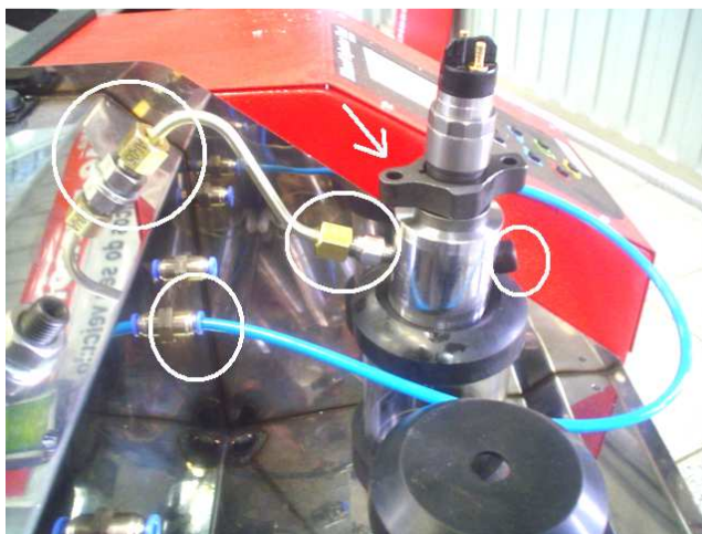
Injetor 0 445 120 007 no adaptador AI-05 Conexão B conectado na TM 507-III
