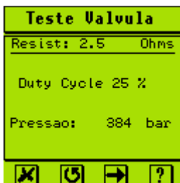
Tela de teste de válvula: cinco pontos de teste
