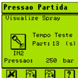
Tela do teste de partida: visualize o spray do injetor
