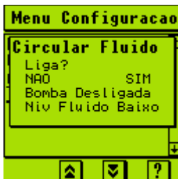
Tela de manutenção do fluido de teste: aguardando nível ok
