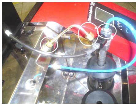
Injetor Bosch conectado na TM 507-III
