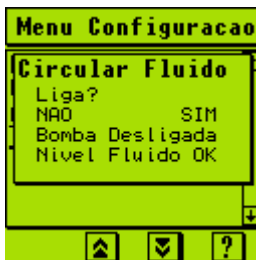
Tela de manutenção do fluido de teste: nível de fluido ok
