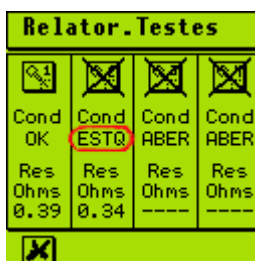
Tela do resultado do teste de estanqueidade
