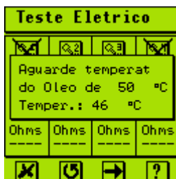
Tela de aquecimento: aquecimento do fluido de teste
