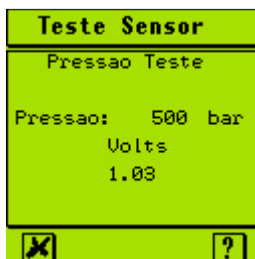
Tela de teste de sensor: cinco pontos de teste.
