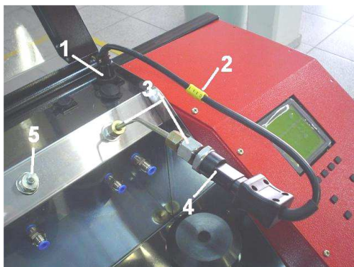
Adaptador AS-02 e o Sensor 0 281 002 568
