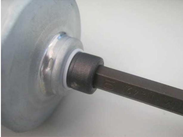
Antes de colocar o filtro no cabeçote, passe um pouco de fluido ou óleo mineral no anel de borracha para facilitar o aperto.
