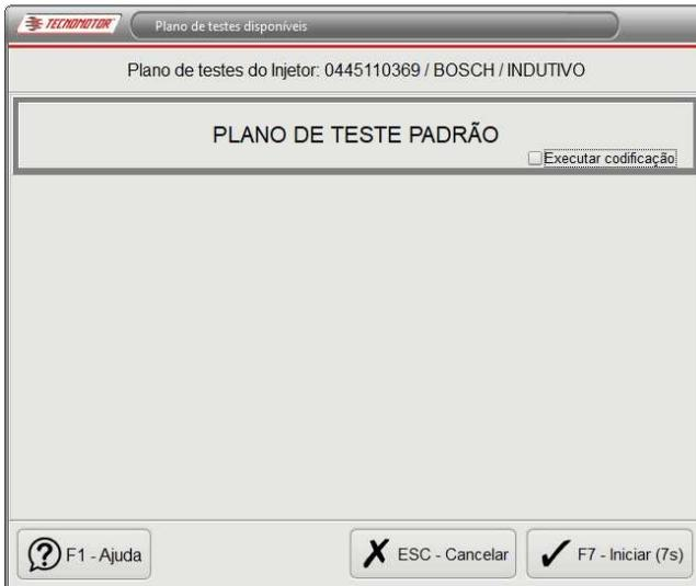
O software irá realizar o teste elétrico, caso a resistência da válvula esteja OK, será iniciado o teste de vazão.
