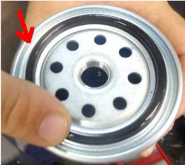
Coloque o filtro no cabeçote, rosqueie até o anel encostar no cabeçote. Após o encosto, rosquear mais  $\frac{3}{4}$  de volta a 1 volta.
