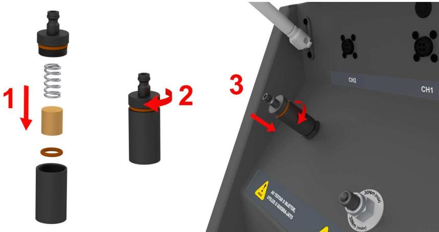
1- Posicione os componentes como a imagem acima (1). **Atenção à orientação do filtro sinterizado: a face fechada do filtro deve ficar em contato com a mola.**
