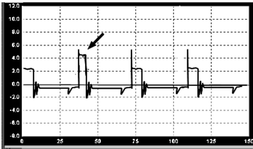
**Tensão de centelha baixa:** causada por baixa resistência no sistema
