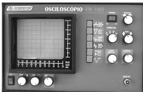
**osciloscópio analógico automotivo**
