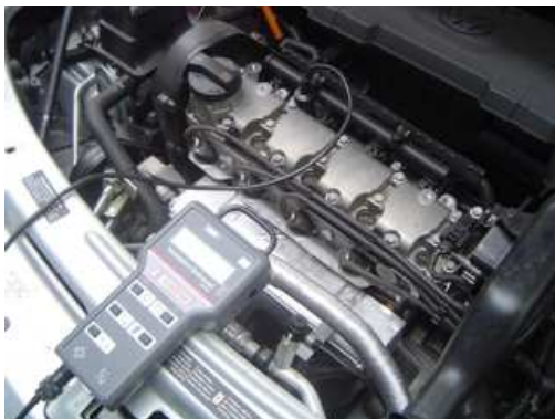
Captura pelo sinal da bateria (ripple do alternador)
