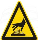
O perigo de queimadura existe ao trabalhar num motor quente se tocar em componentes como o colector de escape, o turbocompressor, a sonda Lambda, etc. ou se chegar demasiado perto deles. Estes componentes podem atingir temperaturas de centenas de graus Celsius.
