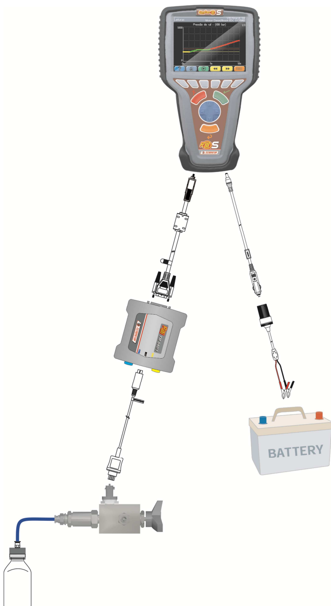
Conexión del manifold y o sensor de presión al Rasther y TM 540/1 Rai (Osciloscopio)
