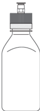
Frasco coletor da válvula de segurança
