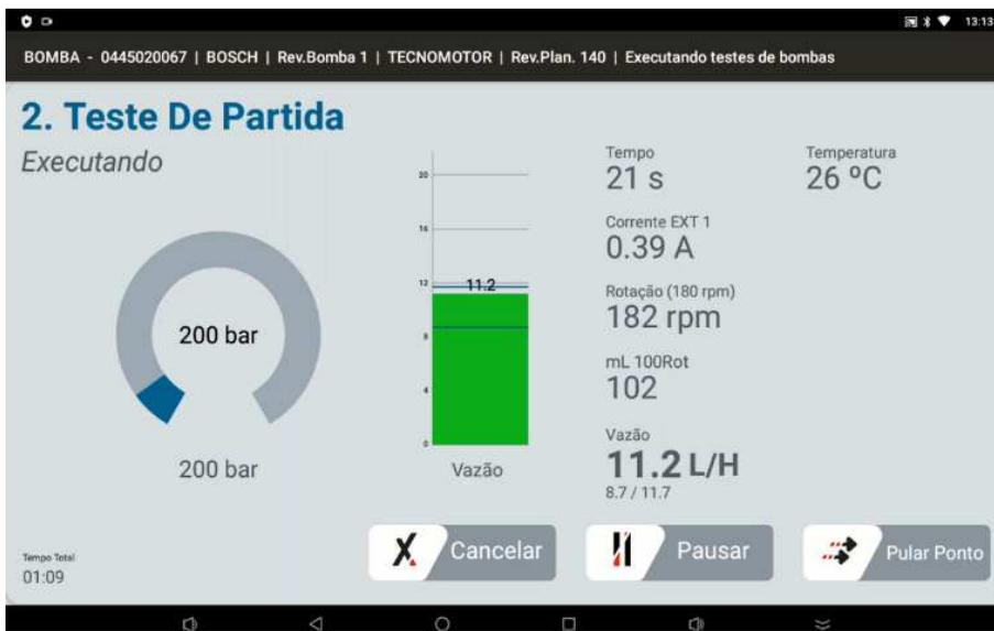
Ajuste a rotação de teste, de acordo com as instruções na tela. Siga as instruções até o final do teste.
