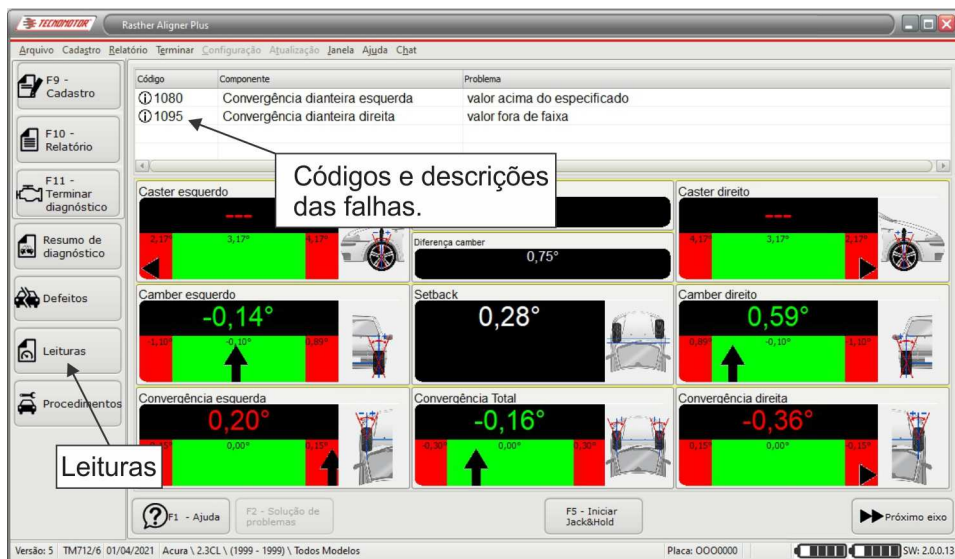
Tela contendo a lista de falhas e as escalas com as medidas.
